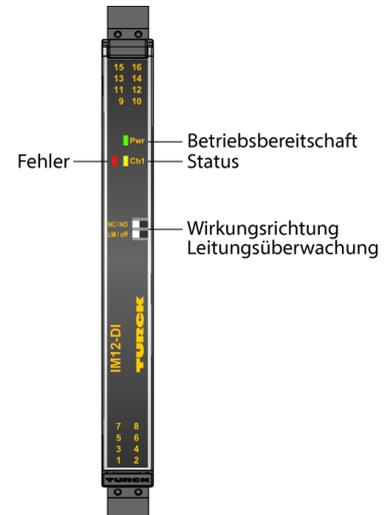
An den NAMUR-Repeater IM12-DI03-1S-1NAM1T-PR/24VDC/CC können Sensoren nach EN 60947-5-6 (NAMUR) oder potenzialfreie Kontakte angeschlossen werden. Das kann in Zone 2 montiert werden. Der Ausgangskreis ist zusätzlich mit einem Transistorausgang ausgestattet. Das Gerät kann über eine Power-Bridge versorgt werden, die auch eine Sammelstörmeldung überträgt. Das Gerät erfüllt die Anforderungen der NE21.
