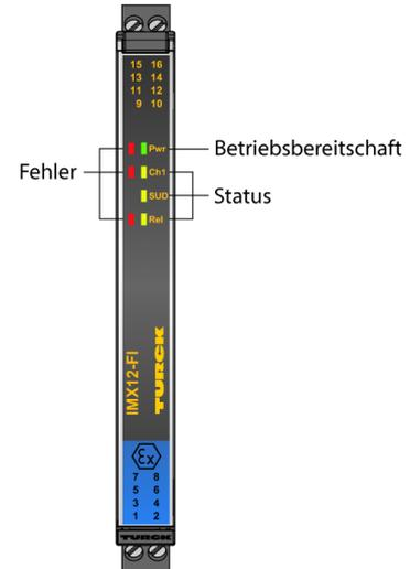
Der Frequenzmessumformer IMX12-FI01-1SF-1R-0/24VDC ist mit eigensicheren Eingangskreisen ausgestattet und überträgt Frequenzsignale bis 20000 Hz galvanisch getrennt aus dem explosionsgefährdeten Bereich in den sicheren Bereich. Mit dem Gerät können Grenzwerte überwacht werden. Das Gerät ist für den Betrieb in Zone 2 geeignet.
