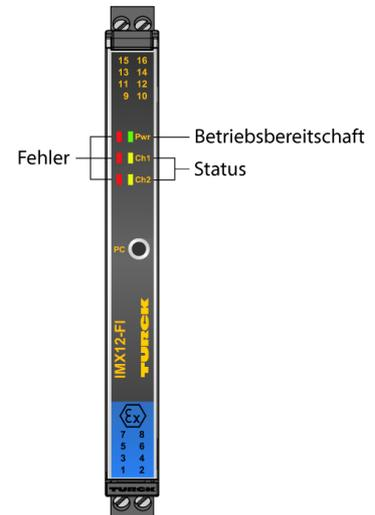
Der Frequenzmessumformer/Puls-Counter IMX12-FI01-2SF-2I-C0/24VDC ist mit eigensicheren Eingangskreisen ausgestattet und überträgt Frequenzsignale bis 20000 Hz galvanisch getrennt aus dem explosionsgefährdeten Bereich in den sicheren Bereich. Zusätzlich können die Eingangssignale auf Schlupf überwacht werden. Die Geräte sind für den Betrieb in Zone 2 geeignet.
