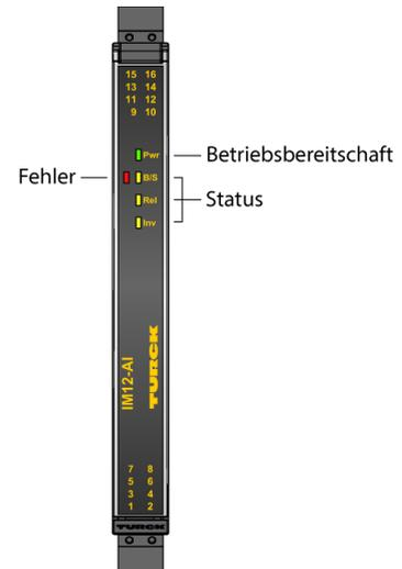
Die Messumformer-Speisetrenner IM12-AI01-1I-1IU1R-H... übertragen das analoge Messsignal galvanisch getrennt. Zusätzlich überwachen die Geräte die Eingangssignale auf Über- oder Unterschreiten eines einstellbaren Grenzwerts. Die Geräte sind für den Betrieb in Zone 2 geeignet. An den Geräten können passive 2-Draht-Messumformer sowie aktive und passive HART-Transmitter betrieben werden.
