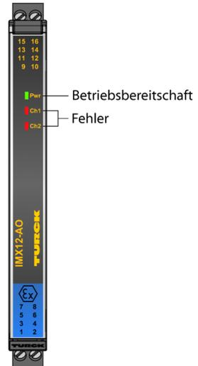
Über den 2-kanaligen Signaltrenner IMX12-AO01-2I-2I-HPR/24VDC wird das normierte Stromsignal 1:1 galvanisch getrennt aus dem Nicht-Ex-Bereich in den Ex-Bereich übertragen. Neben dem Analogsignal können bidirektional auch digitale Signale der HART®-Kommunikation übertragen werden. Typische Anwendungen sind die Ansteuerung von I/P-Wandlern oder Anzeigeegeräten im Ex-Bereich. Das Gerät kann über eine Power-Bridge versorgt werden, die auch eine Sammelstörung überträgt.
