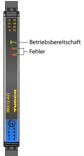
Über den 2-kanaligen Signaltrenner IMX12-AO01-2I-2I-HPR/24VDC/CC wird das normierte Stromsignal 1:1 galvanisch getrennt aus dem Nicht-Ex-Bereich in den Ex-Bereich übertragen. Neben dem Analogsignal können bidirektional auch digitale Signale der HART®-Kommunikation übertragen werden. Typische Anwendungen sind die Ansteuerung von I/P-Wandlern oder Anzeigegeräten im Ex-Bereich.
