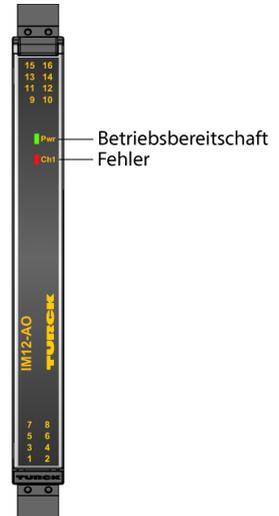
Über den 1-kanaligen Signaltrenner IM12-AO01-1I-1I-H0/24VDC/CC wird das normierte Stromsignal 1:1 galvanisch getrennt übertragen. Neben dem Analogsignal können bidirektional auch digitale Signale der HART®-Kommunikation übertragen werden. Typische Anwendungen sind die Ansteuerung von I/P-Wandlern oder Anzeigegeräten.
