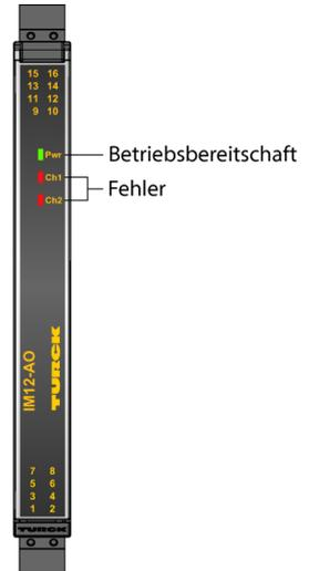
Über den 2-kanaligen Signaltrenner IM12-AO01-2I-2I-HPR/24VDC/CC wird das normierte Stromsignal 1:1 galvanisch getrennt übertragen. Neben dem Analogsignal können bidirektional auch digitale Signale der HART®-Kommunikation übertragen werden. Typische Anwendungen sind die Ansteuerung von I/P-Wandlern oder Anzeigegeräten.
