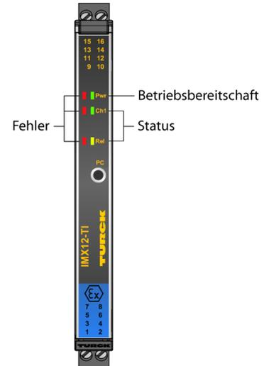
Der 1-kanalige Temperatur-Messverstärker IMX12-TI02-1TCURTDR-1I1R -C0/24VDC verfügt über Eingänge für: Thermoelemente nach IEC 60584, DIN 43710, GOST R 8.585-2001, Kleinspannungen (-150...+150 mV), RTDs nach IEC 60751, DIN 43760, GOST 6651-94 (2-, 3- und 4-Leiter) sowie Widerstände 0...5 kΩ (2-, 3- und 4-Leiter)..
