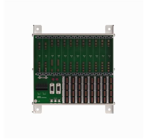
Der Modulträger MT08-N besteht aus einer Backplane und dem eigentlichen Trägersystem. Er dient zur Aufnahme von zwei Gateways, zwei Netzteilen sowie 8 E/A-Modulen. Es können so bis zu 64 binäre Ein-/Ausgänge oder 32 analoge Ein-/Ausgänge bzw. jede Mischform an den Modulträger angeschlossen werden.
