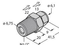
Klemmringverschraubung zur Direktmontage von Temperaturfühlern; Fühlerdurchmesser 6 mm; Prozessanschluss 1/2"NPT Außengewinde
