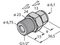
Klemmringverschraubung zur Direktmontage von Temperaturfühlern; Fühlerdurchmesser 6 mm; Prozessanschluss G1/2" Außengewinde
