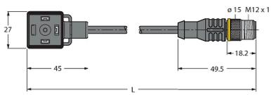
Cable de extensión, conector de válvula, tipo A a conector macho M12, recto, de 5 polos, longitud del cable: 0.6 m; material de revestimiento: PUR, negro
