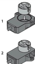
Existen dos opciones de montaje diferentes. Una opción es colocar el elemento de posicionamiento sobre la carcasa del sensor. Sin embargo, también se puede montar de modo que la carcasa del sensor encierre completamente el elemento de posicionamiento.
