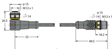
Cable de extensión, conector hembra M12, acodado, de 4 polos a conector macho M12, recto, de 4 polos; longitud del cable: 2 m; material de revestimiento: PUR, negro; aprobación cULus
