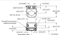
Soporte de montaje; llave de tamaño variable de 24 a 30 mm; placa de etiquetado extraíble de 20 x 9 mm
