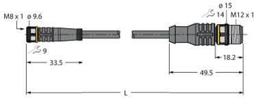
Cable de extensión, conector hembra M8, recto, de 4 polos a conector macho M12, recto, de 4 polos; longitud del cable: 2 m; material de revestimiento: PUR, negro; aprobación cULus
