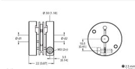
Acoplamiento de arandela de bloqueo Ø 30 mm, d1 = 10 mm, d2 = 12 mm
