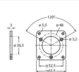
Adaptador de brida cuadrado en aluminio para codificador rotatorio de eje macizo con brida de sujeción; longitud del canto 63,5 mm; grosor 3 mm
