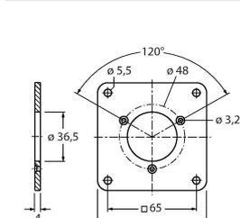
Adaptador de brida cuadrado en aluminio para codificador rotatorio de eje macizo con brida de sujeción; longitud del canto 80 mm; grosor 4 mm
