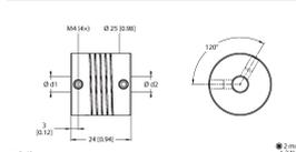
Acoplamiento helicoidal de aluminio Ø 25 mm; d1 = 10 mm, d2 = 12 mm
