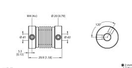
Acoplamiento de fuelles con concentrador de aluminio Ø 20 mm; d1 = 8 mm, d2 = 12 mm
