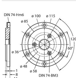
Euroflansch - Adaptador de brida en aluminio para codificador rotatorio de eje macizo, Ø 115 mm; diámetro del círculo primitivo 100 mm; para la conversión de la brida de sujeción de 58 mm a brida Euroflansch
