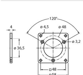
Adaptador de brida cuadrado en aluminio para codificador rotatorio de eje macizo con brida de sujeción; longitud del canto 58 mm; grosor 4 mm
