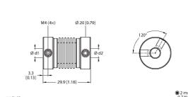
Acoplamiento de fuelles de acero inoxidable Ø 20 mm; d1 = 10 mm, d2 = 12 mm
