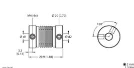
Acoplamiento de fuelles con concentrador de aluminio Ø 20 mm; d1 = 10 mm, d2 = 12 mm
