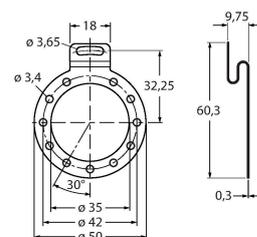
Chapa de sujeción en acero inoxidable para codificador rotatorio de eje hueco, diámetro del círculo primitivo 64,5mm, para aplicaciones con juego axial y radial, en caso de dinámica reducida
