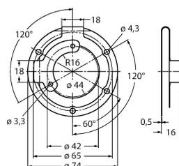
Acoplamiento de estator en acero inoxidable para codificador rotatorio de eje hueco, diámetro del círculo primitivo 65 mm, para aplicaciones con juego axial y radial, en caso de dinámica elevada
