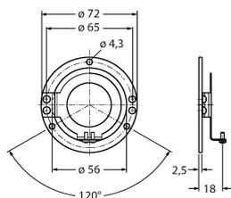
Acoplamiento de estator en acero inoxidable para codificador rotatorio de eje hueco, diámetro del círculo primitivo 65mm, para aplicaciones estándar con juego axial y radial, en caso de dinámica elevada
