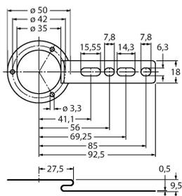
Chapa de sujeción en acero inoxidable para codificador rotatorio de eje hueco, diámetro del círculo primitivo 80...170mm, para aplicaciones con juego axial y radial, en caso de dinámica reducida
