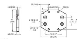
Placa adaptadora para el montaje de la carcasa QR20 con orificios de montaje para la carcasa Q20L60
