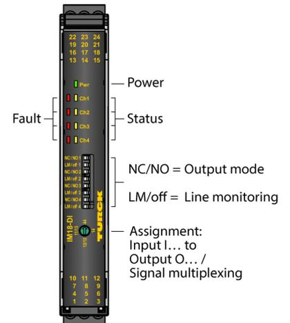
Los amplificadores separadores IM18-DI03... permiten la transmisión de señales binarias con aislamiento galvánico. En el aparato se pueden conectar sensores en conformidad con la norma EN 60947-5-6 (NAMUR) o contactos libres de potencial. Los dispositivos también son adecuados para su funcionamiento en la Zona 2.
