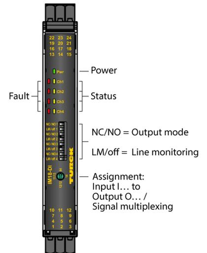
Los amplificadores separadores IM18-DI03... permiten la transmisión de señales binarias con aislamiento galvánico. En el aparato se pueden conectar sensores en conformidad con la norma EN 60947-5-6 (NAMUR) o contactos libres de potencial. Los dispositivos también son adecuados para su funcionamiento en la Zona 2.
