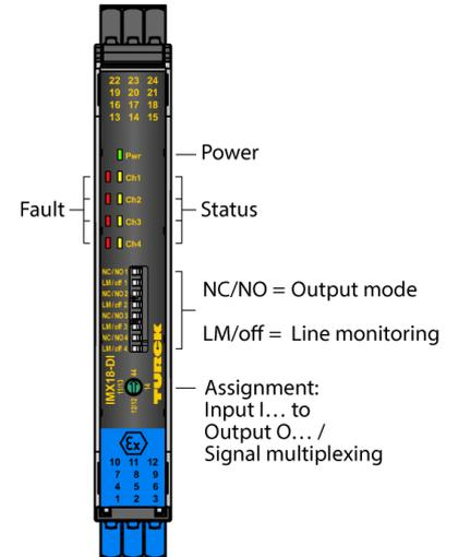
Los amplificadores separadores IMX18-DI03... están equipados con circuitos de entrada de seguridad intrínseca y señales binarias de transferencia desde el área con peligro de explosiones hacia el área sin peligro de explosiones. En el aparato se pueden conectar sensores en conformidad con la norma EN 60947-5-6 (NAMUR) o contactos libres de potencial. Los dispositivos también son adecuados para su funcionamiento en la Zona 2.
