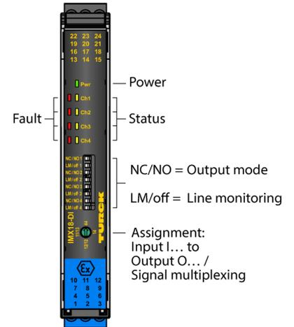
Los amplificadores separadores IMX18-DI03... están equipados con circuitos de entrada de seguridad intrínseca y señales binarias de transferencia desde el área con peligro de explosiones hacia el área sin peligro de explosiones. En el aparato se pueden conectar sensores en conformidad con la norma EN 60947-5-6 (NAMUR) o contactos libres de potencial. Los dispositivos también son adecuados para su funcionamiento en la Zona 2.
