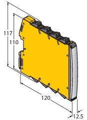
Amplificador-aislador; dos canales; SIL2 conforme a IEC 61508; modelo Ex; 2 salidas de transistor; entrada señal Namur; control desconectable de rotura de hilo y cortocircuito; conmutable entre modo de corriente de trabajo y reposo; duplicación de señal; bornes roscados extraíbles; ancho 12,5 mm; tensión de alimentación de 24VDC
