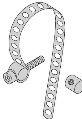
Montaje en cilindros redondos; diámetro del cilindro de 25...80 mm; material: metal A2 1.4301 (AISI 304), dos pernos de fijación (material: metal CuZn, como alternativa metal A2 1.4301 / AISI 304) tornillo del cilindro M3 x 20 (DIN 912-A20)
