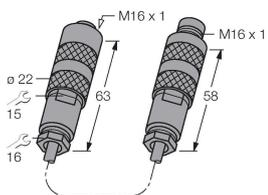
El cable adaptador permite el montaje por separado de la sonda anular y del amplificador de conmutación; cable coaxial: RG58 C/U 50 Ohm
