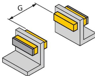
El sensor puede montarse en ambos lados largos a ras con el metal.
