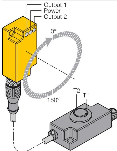
programación de los puntos de conmutación mediante el adaptador de teach TX1-Q20L60. Cuando se acciona el conmutador T1 (SALIDA 1), se forma un puente entre la conexión a tierra y la patilla 5. Cuando se acciona el conmutador T2 (SALIDA 2), se forma un puente entre el UB y la patilla 5. Se puede seleccionar puntos de activación y desactivación libres en todo el rango de inclinación de 360°.
