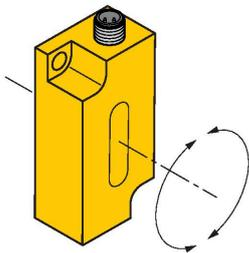
Ajuste del rango de medición mediante el adaptador teach TX1-Q20L60
