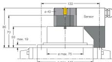
Kit de montaje para sensores dobles para actuadores rotativos grandes; Ø de la placa espaciadora y arandela elástica: máx. 110 mm; patrón de agujeros en la superficie del receptáculo: 30 x 130 mm; altura del eje de conexión (extensión del eje): 50 mm/Ø: máx. 75 mm
