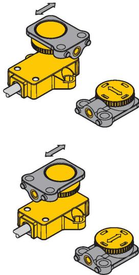
Se consigue máxima flexibilidad en el montaje con la opción de fijar el transductor de posición girado 90°.
