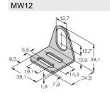
6945003 Soporte de montaje para sensores de tubo roscado; material: acero inoxidable A2 1.4301 AISI 304)
