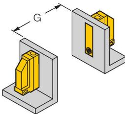
Los sensores pueden estar montados directamente unos al lado de otros, cuando un sensor es utilizado con oscilador de frecuencia compensado Bi5U-Q12.../F2.
