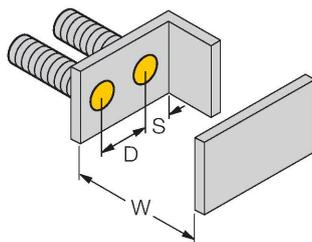
El montaje rebajado es admisible con todos los interruptores de tubo roscado aprox+ de montaje enrasado. Se logra una operación segura si el sensor se enrosca a media vuelta.
