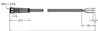
Cable de conexión, conector hembra M8, recto, de 3 polos, longitud del cable: 2 m; material de revestimiento: PVC, negro; aprobación cULus
