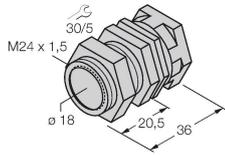
Abrazadera de montaje rápido con tope, material: Latón cromado. Rosca macho M24 × 1.5. Nota: La distancia de conmutación de los interruptores de proximidad puede variar por el uso de soportes de montaje rápido.
