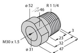
adaptador de montaje; material: polipropileno; posibilidad de cambio de sensor cuando se cuenta con el depósito lleno (el adaptador se conserva en el depósito durante el intercambio del sensor)
