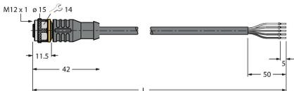
Cable de conexión, conector hembra M12, recto, de 5 polos, longitud del cable: 2 m; material de revestimiento: PVC, negro; aprobación cULus
