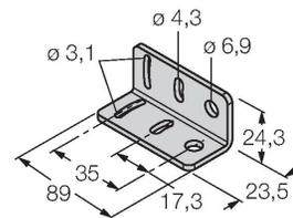
ángulo de montaje, acero inoxidable, para el modelo MINI-BEAM NAMUR
