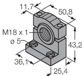
soporte de montaje, PBT negro, para sensores con rosca de 18mm, orientable
