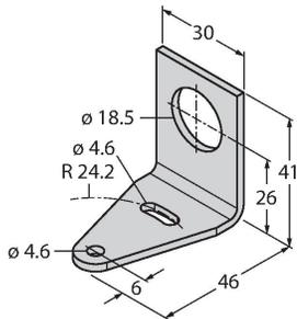
Soporte de montaje, en ángulo recto, acero inoxidable, para sensores con rosca de 18mm
