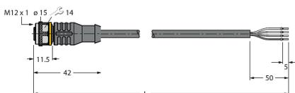
Cable de conexión, conector hembra M12, recto, 4 polos, longitud de cable: 2m, material de la funda: PVC, negro; homologación cULus; disponibles otras longitudes de cable y variantes, véase [www.turck.com](http://www.turck.com)
