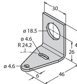
Soporte de montaje, en ángulo recto, acero inoxidable, para sensores con rosca de 18mm
