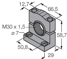
Soporte de montaje, PBT negro, para sensores con rosca de 30mm, orientable
