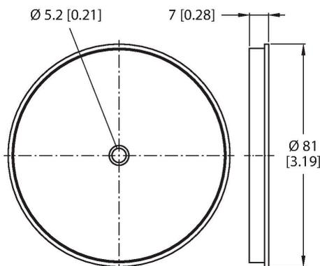
Reflector redondo, coeficiente de reflexión 1,0, material acrílico, temperatura ambiente de -20...+60 °C
