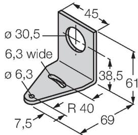
Ángulo de montaje, en ángulo recto, acero inoxidable, para sensores con rosca de 30 mm
