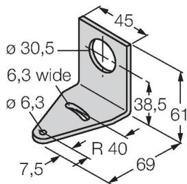
Ángulo de montaje, en ángulo recto, acero inoxidable, para sensores con rosca de 30 mm
