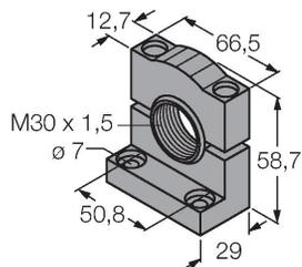
Soporte de montaje, PBT negro, para sensores con rosca de 30mm, orientable
