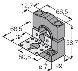
escuadra de montaje, PBT negro, con placa de montaje, acero inoxidable, para los modelos con rosca de 18mm, QM42/QMT42
