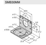
Escuadra de montaje, en ángulo recto, acero inoxidable, para sensores con rosca de 30 mm, perforaciones adicionales para un orientación exacta
