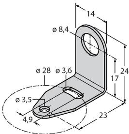
ángulo de montaje, material VA 1.4401, para sensores de la serie constructiva T8 ó T8L
