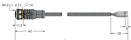
Dibujo acotado Tipo RKC4.4T-2/TEL N.º de ID 6625013
